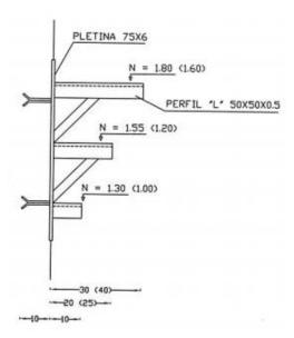
En caso de que en la cámara se cuente con una pared con más longitud, se podrá cambiar la configuración indicada en el diagrama, previa coordinación con el fiscalizador del contrato.
