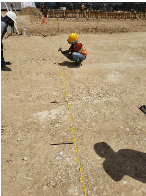
Medición de resistividad del suelo
