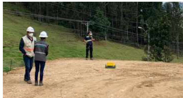
Revisión de la de la zona Sur-Oeste donde se implantará el cerramiento perimetral Prueba de densidades, con densímetro nuclear, de plataforma y vías de la subestación
