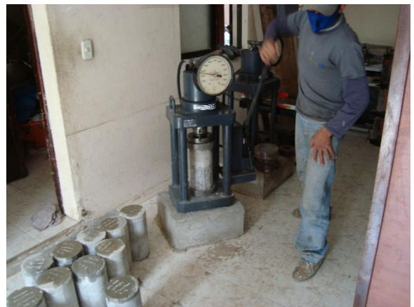
Rotura de probetas de hormigón
