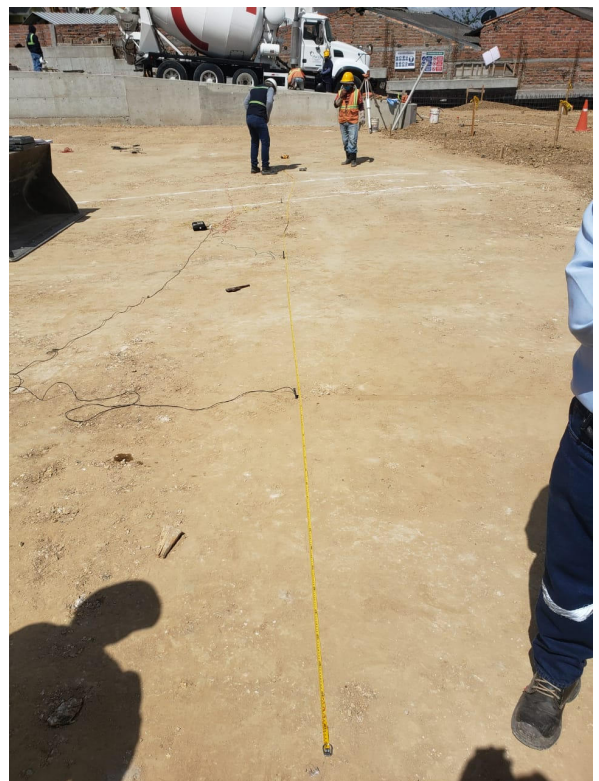
Medición de resistividad del suelo
