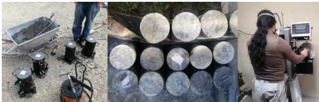
Toma de muestras de hormigón y ensayo de resistencia a la compresión en laboratorio aprobado
